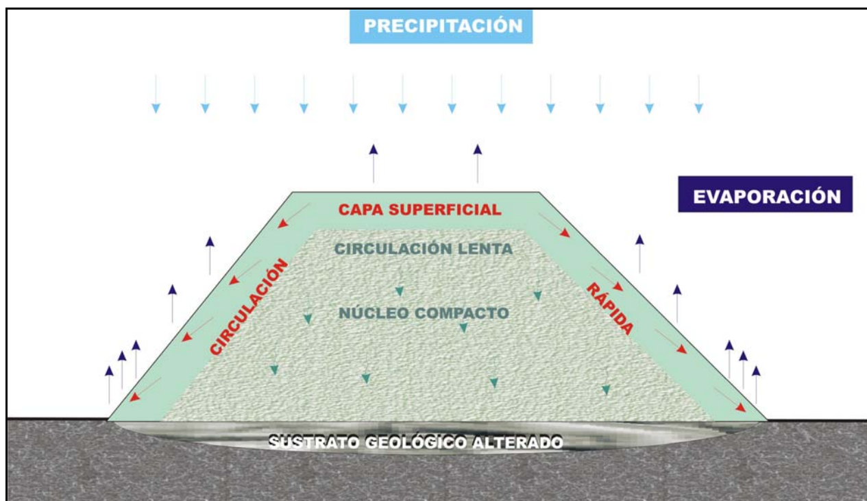
Figura 4. Esquema conceptual de un depósito salino.
