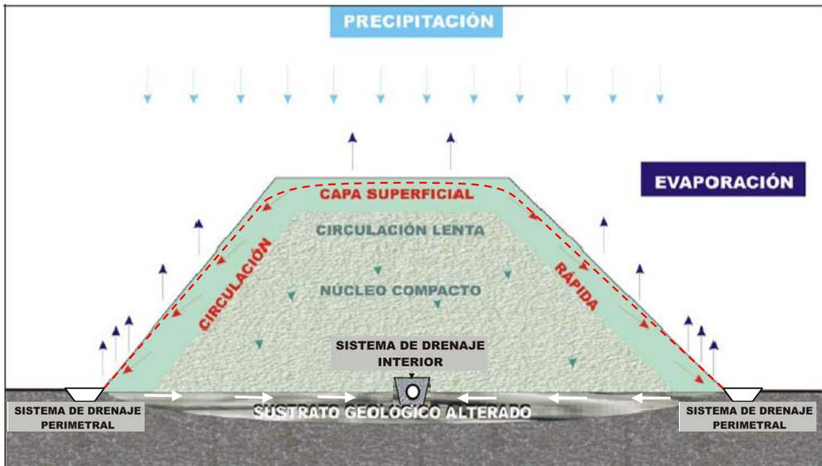
Figura 12. Modelo conceptual de drenaje del depósito salino actual.
