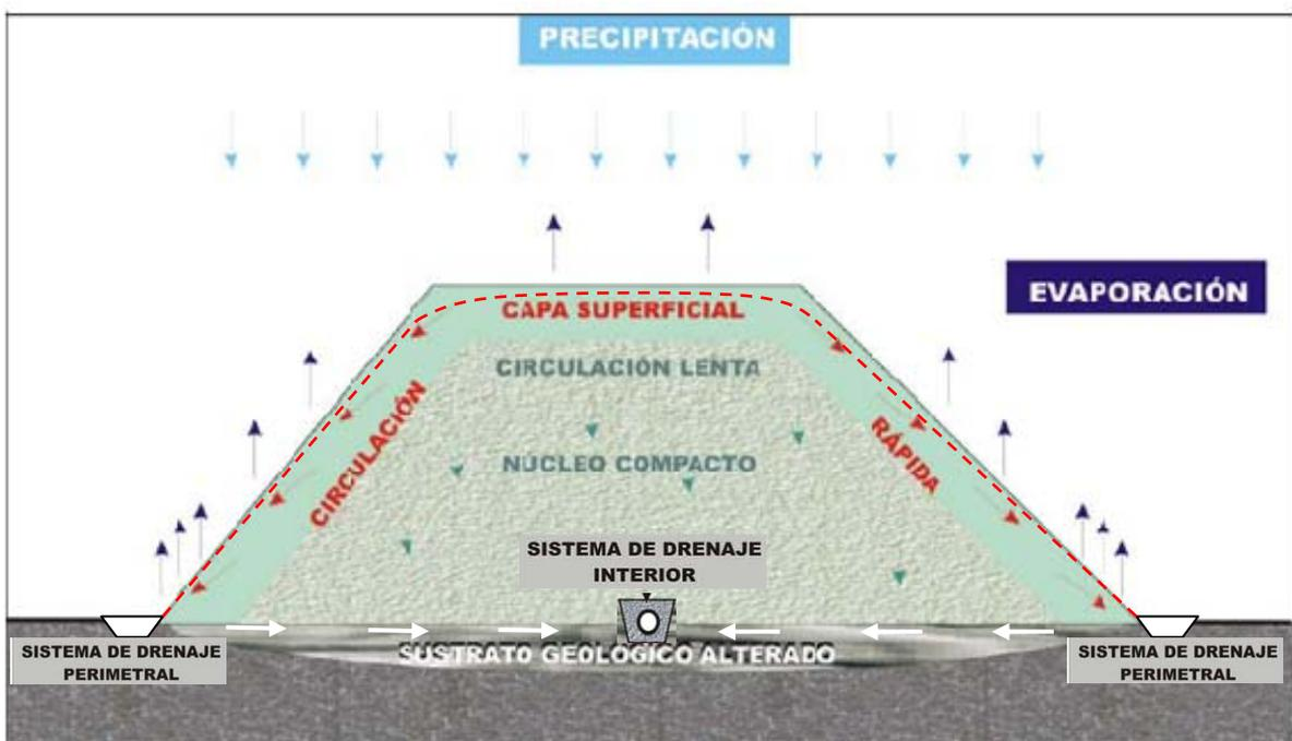
Figura 7. Modelo conceptual de drenaje del depósito salino.
