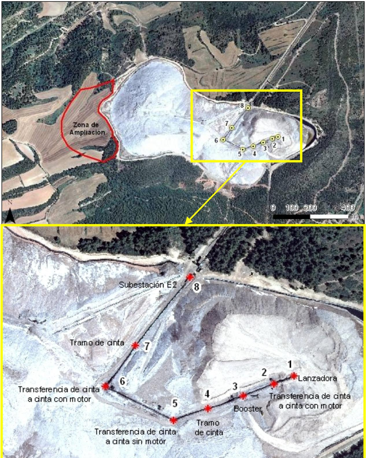
Figura 23. Localización de puntos de medida de emisión acústica en el depósito.
